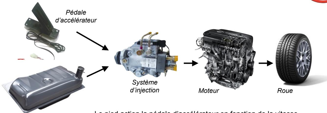
Le pied action la pédale d'accélérateur en fonction de la vitesse souhaitée. Un capteur d'effort permet d'acquérir cet effort. Il est ensuite traité par un microcontrôleur puis communiqué au système d'injection, qui délivre l'essence en fonction au moteur. Le moteur transmet ensuite le mouvement aux roues.
