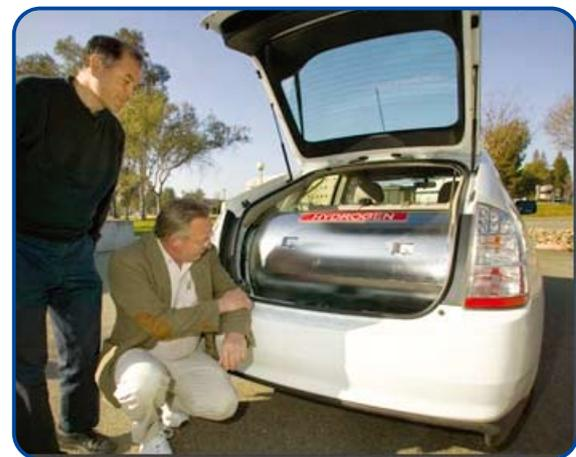
Figure 6-7 Prototype de réservoir d'hydrogène liquide.
