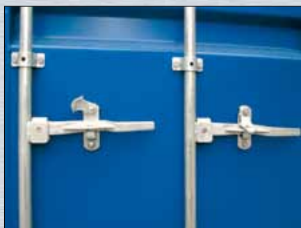
Fermetures de portes forgées et galvanisées
